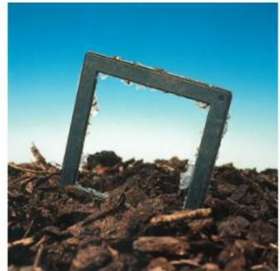
Bild 3. Der fossil-basierte, bioabbaubare Kunststoff Ecoflex erfüllt die strengen Anforderungen der wichtigsten internationalen Normen für Bioabbaubarkeit und Kompostierbarkeit: Das Bild zeigt von links nach rechts den Zerfall einer Ecoflex-Folie innerhalb von vier Wochen im 55 °C warmen Kompost
