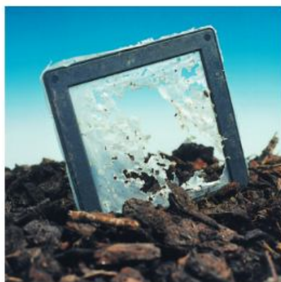
Bild 3. Der fossil-basierte, bioabbaubare Kunststoff Ecoflex erfüllt die strengen Anforderungen der wichtigsten internationalen Normen für Bioabbaubarkeit und Kompostierbarkeit: Das Bild zeigt von links nach rechts den Zerfall einer Ecoflex-Folie innerhalb von vier Wochen im 55 °C warmen Kompost
