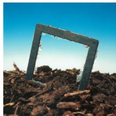
Bild 3. Der fossil-basierte, bioabbaubare Kunststoff Ecoflex erfüllt die strengen Anforderungen der wichtigsten internationalen Normen für Bioabbaubarkeit und Kompostierbarkeit: Das Bild zeigt von links nach rechts den Zerfall einer Ecoflex-Folie innerhalb von vier Wochen im 55 °C warmen Kompost
